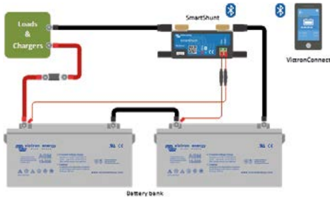
Akü şarj ünitesi orta noktasını ölçme
